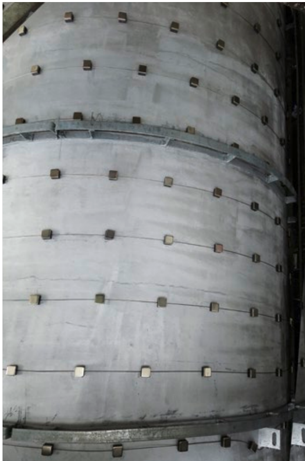
Przykład zastosowania - monitorowanie powierzchni reaktora: Przewód czujnika wysokotemperaturowego w rurce ze stali nierdzewnej i wysokotemperaturowe uchwyty magnetyczne ułożone w meandryczny kształt.
